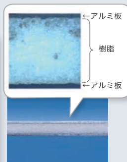
アルミ樹脂多層材断面図
